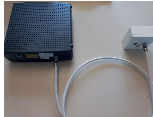
Foto: Kabel-Modem und Multimediadose
